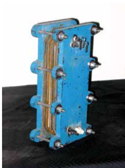
Figura 9 - Um dos primeiros módulos de eletrodeionização (1977).
